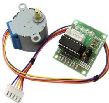
Рис. 20. Шаговый двигатель 28BYJ-48
