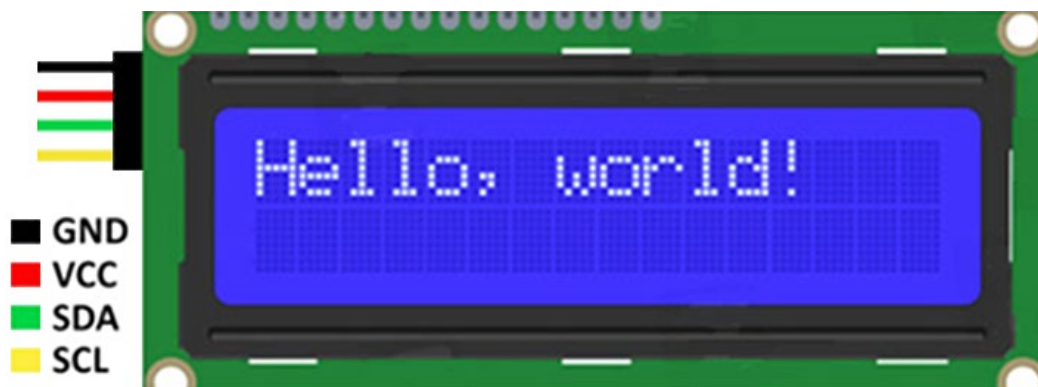
Рис. 1. Подключение модуля ЖКИ к Ардуино
