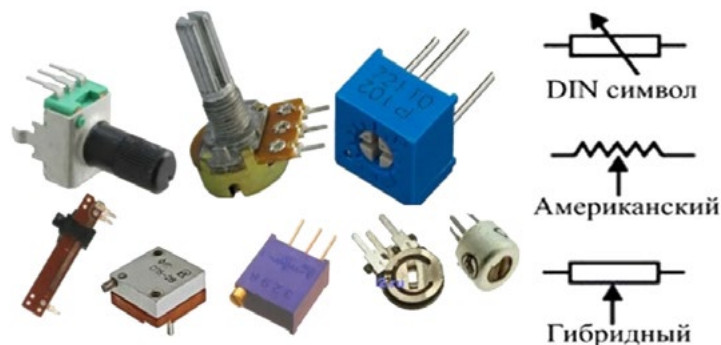
Рис. 10. Переменные резисторы (потенциометры)
