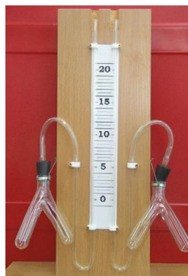
Рис. 19. Прибор для определения скорости химических реакций
