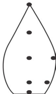
Рис. 8. Точки измерения температуры пламени
